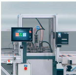
Steuerung, Touch-Screen-Monitor, Scanner sowie Zu- und Abtransportpuffer sind übersichtlich angeordnet. Der Bediener konzentriert sich aufs Wesentliche, ohne abgelenkt zu werden. Alle Maschinen sind komplett ausgestattet, inklusive Anschluss an vorhandene Absauganlagen (Ø 160 mm). Optional kann eine Absauganlage geliefert werden. Alle unsere Maschinen werden individuell auf die Kundenwünsche abgestimmt.
